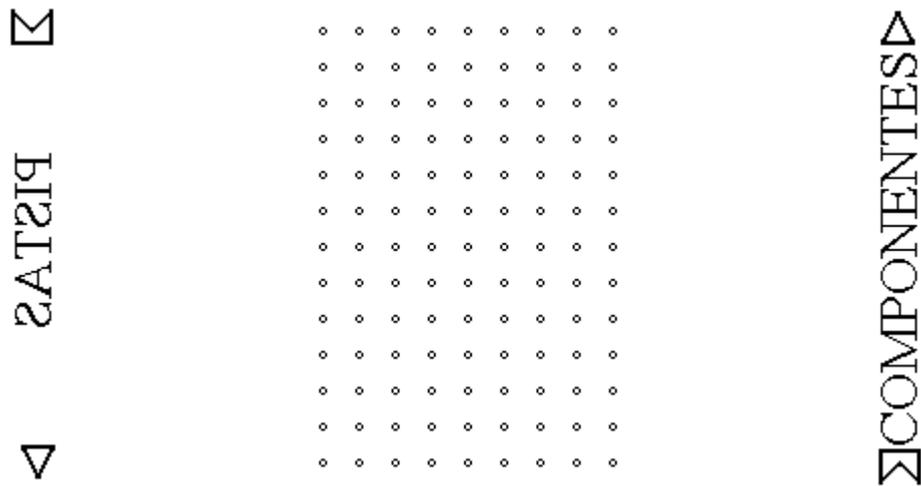
5. Para el diseño de las soldaduras, imagina que miramos la placa por detrás. Dibuja ahora la posición de las **patillas de los componentes con lápiz azul**. Recuerda que deben estar **invertidos como en un espejo** que estuviera situado debajo.
