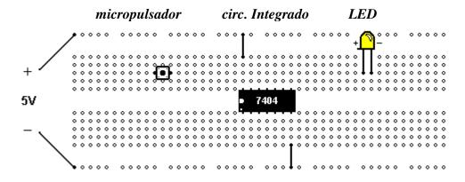
Recuerda: debe alimentarse el circuito integrado, con 5V en la patilla 14 y 0V en la patilla 7
