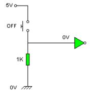
Cuando el pulsador está cerrado (1 - ON) la señal a la entrada de la puerta es 5V. Prácticamente toda la corriente se introduce por la entrada de la puerta lógica, pues encuentra menos oposición por esa vía que a través de la resistencia de 1K.
