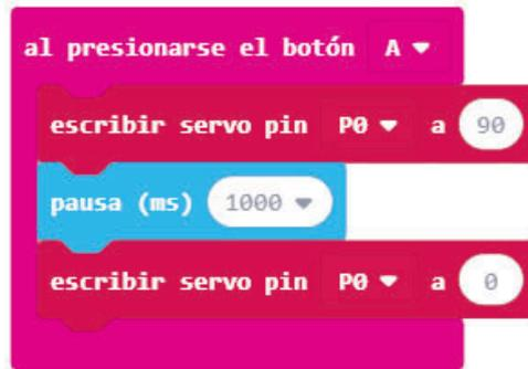
2. Al presionar la flecha hacia arriba del mando, se abre la barrera. Pasado un segundo se cierra automáticamente.
